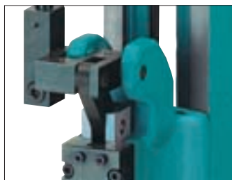
Přemístitelná ovládací ruční páka lisů ERGOPRESS® pro ovládání levorukou obsluhou
